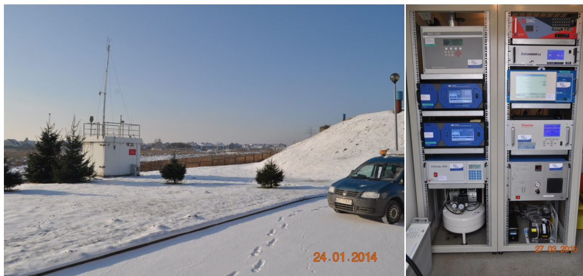
Fotografia 7.4. Pomiary PEM i hałasu komunikacyjnego z wykorzystaniem mobilnej stacji (źródło: WIOŚ w Szczecinie)
