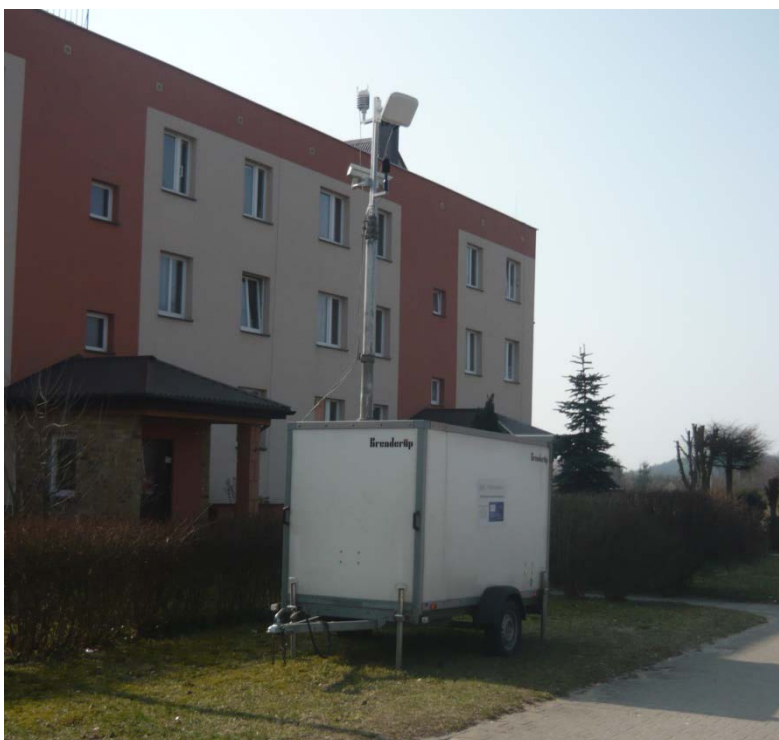
Fotografia 4.2.1. Stacja do automatycznego pomiaru hałasu, Mirosławiec, ul. Wolności (źródło: WIOŚ w Szczecinie)
